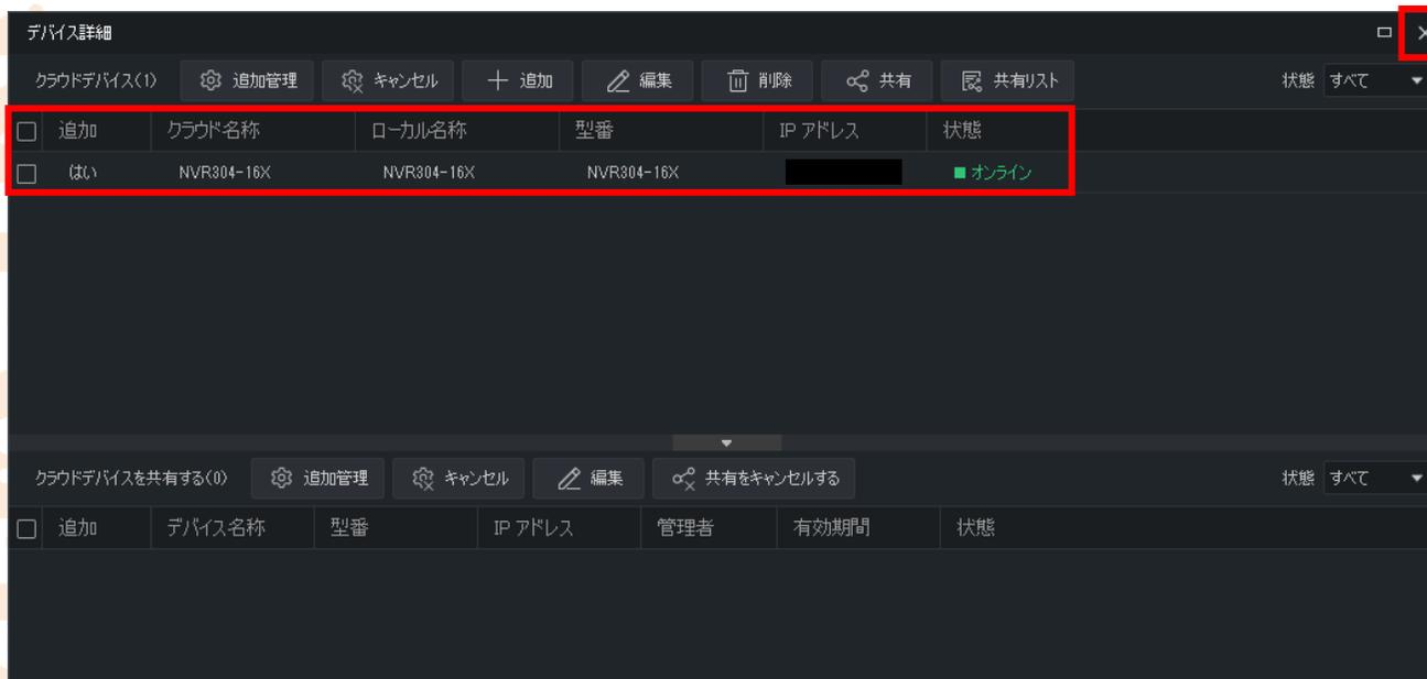
7. デバイス詳細画面に、追加した接続先が表示され、かつ「状態」が「オンライン」になっていることを確認します。確認後、デバイス詳細画面を右上の「×」で閉じます。
